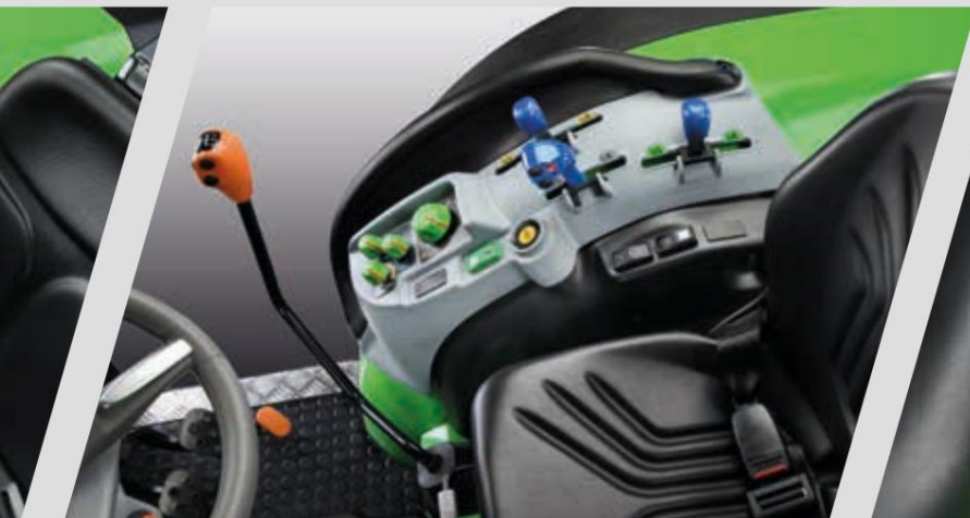
> Udobno elektronsko krmiljenje zadnjega dviga in ventila.
