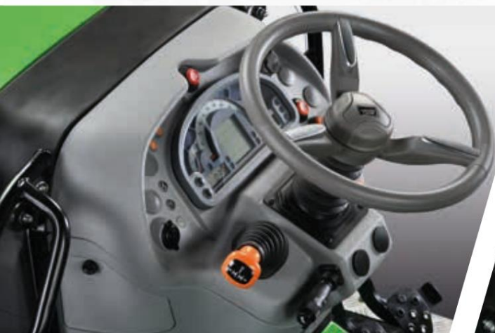
> Mehanski shuttle z ergonomsko ročico na volanu.
