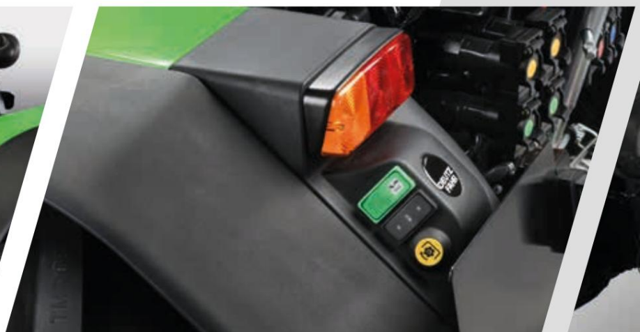
> Zunanji gumbi za zadnji dvig, zadnjo kardansko gred in stranske stabilizatorje poenostavijo manevre priklopa.
