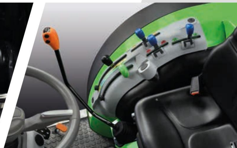
> Natančno mehansko krmiljenje zadnjega dviga in ventila.
