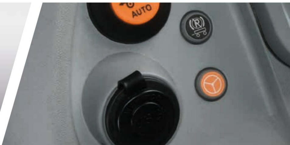
> Funkcija SDD prepolovi število vrtljajev volana, potrebnih za krmiljenje od lock-to-lock.
