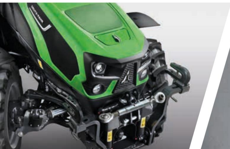
> Elektronsko krmiljeno neodvisno vzmetenje sprednje osi za boljše udobje in oprijem.
