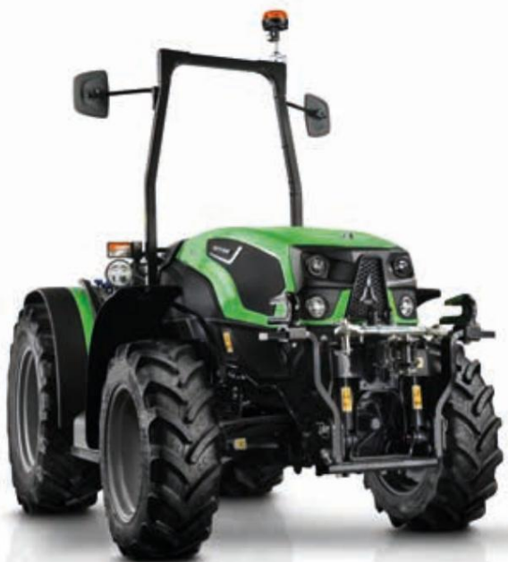
> Popolnoma integriran sprednji dvig in sprednja priključna gred.
