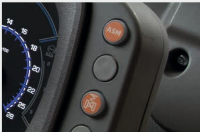
↑ Aktivacija ASM in vzmetenja sprednje osi.
