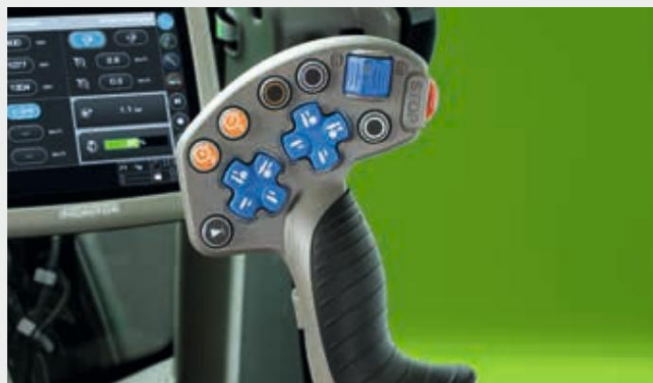
↑ MaxCom krmilna palica za enostavno upravljanje TTV prenosa.
