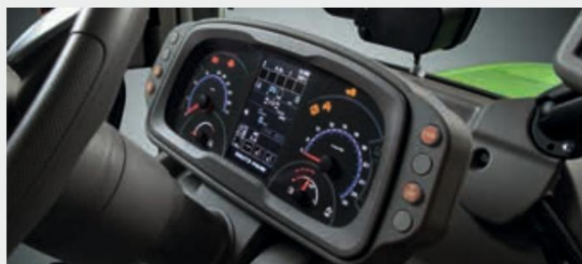
Analogno-digitalna armaturna plošča z glavnimi funkcijami traktorja na prvi pogled.
