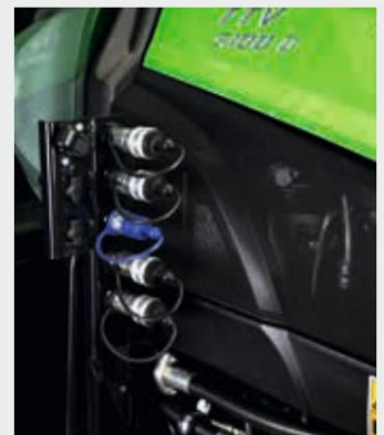
Srednje nameščene hidravlične poti za sprednje priključke.
