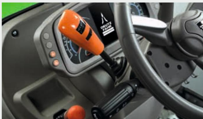
↑ SenseClutch: prilagodljiv odziv odzivnosti in učinkovitosti menjalnika.
