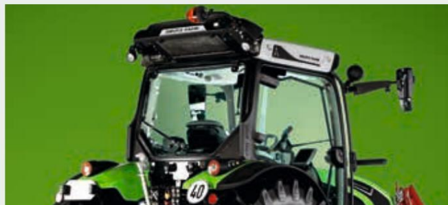
Zadnja dvizna strešna plošča za najboljšo vidljivost nazaj navzgor.
