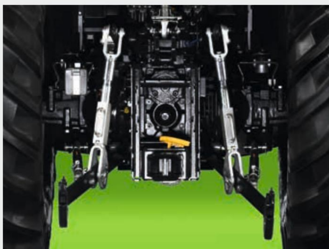
↑ Standardni tritočkovni priklop za večjo dvizno zmogljivost.
