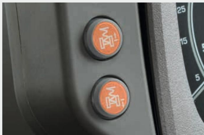
↑ Dva nova namenska gumba, ki omogočata ročno nastavitev položaja prednjega vzmetenja.
