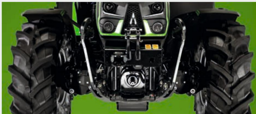
↑ Modeli 5D TTV so lahko opremljeni s sprednjim dvigalom z nosilnostjo 2.100 kg in opcijskim komfortnim paketom.
