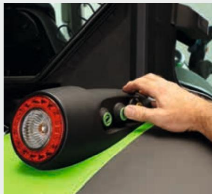
↑ Zadnje dvigalo in priključna gred imata zunanje krmilnike na zadnjih blatnikih.
