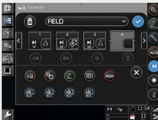
Comfortip dodatno poveča raven udobja. Omogoča snemanje ponavljajočih se nalog in njihov priklic s pritiskom na eno samo tipko.
