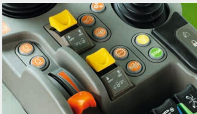
↑ Enostaven vklop sprednje in zadnje kardanske gredi z gumbi na naslonu za roke MaxCom.
