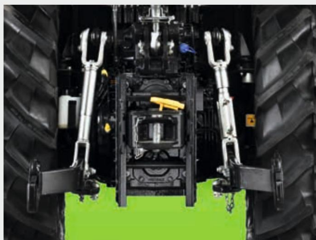
↑ Kompakten tritočkovni priklop za ozko koloteko.
