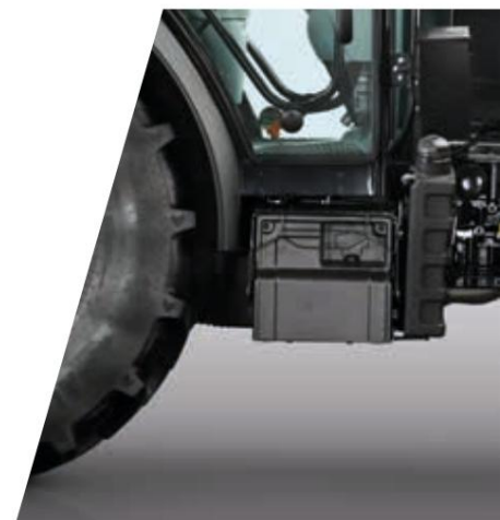
> Veliko in dobro integrirano dizelsko gorivo rezervoar.
