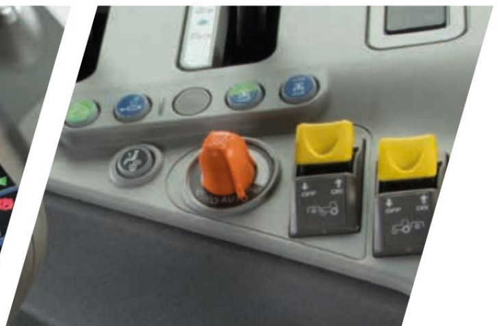
> Enostavno in intuitivno – z gumbom za nastavev ECO/Power lahko upravljaec spremeni vedenje prestavljanja APS (Samodejno Powershift).
