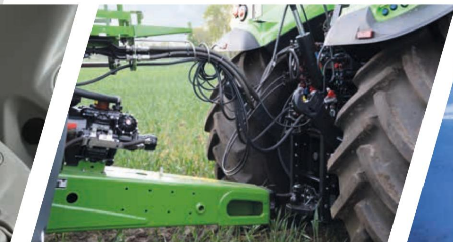
> Zadnja povezava s transportnim položajem, tako da spodnji vlečni drogovi ne trčijo ob ojesa pri zavijanju (za 6190 TTV - 6230 HD TTV).
