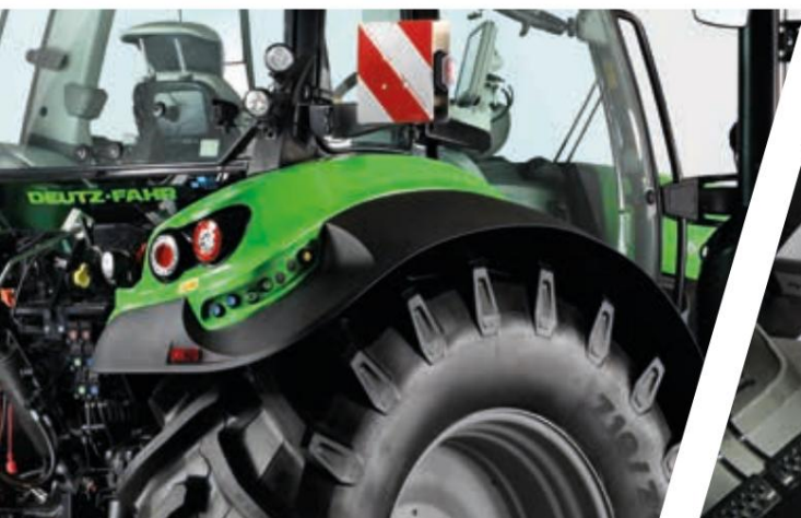
> Zunanji krmilniki na obeh straneh za zadnji dvig, priključno gred in do en ventil.
