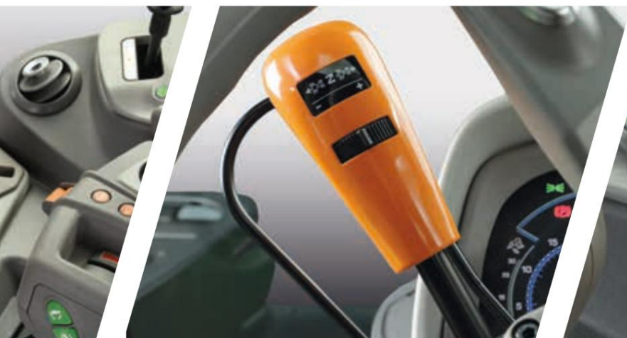
> Ročica PowerShuttle z nastavitvenim gumbom SenseClutch.
