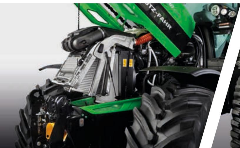
> Aluminijast hladilni sistem Performance+ z enoročno sprostitvijo vzvod za modele 6160-6190.
