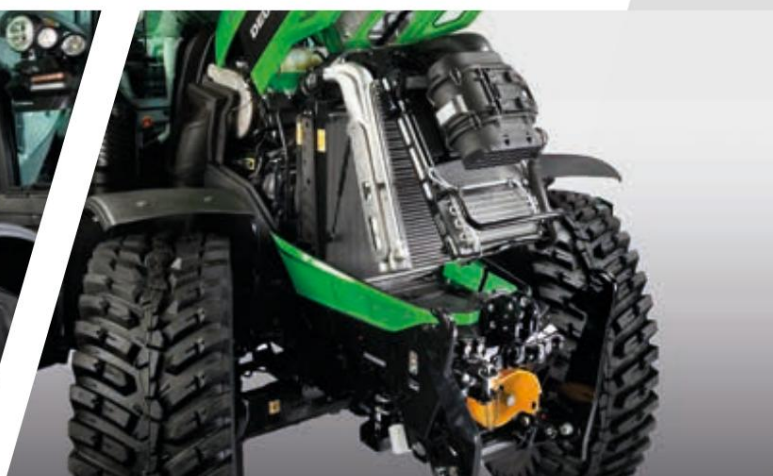
> Aluminijast hladilni sistem PerformancePro z enoročno sprostitveno ročico za modele 6210-6230.
