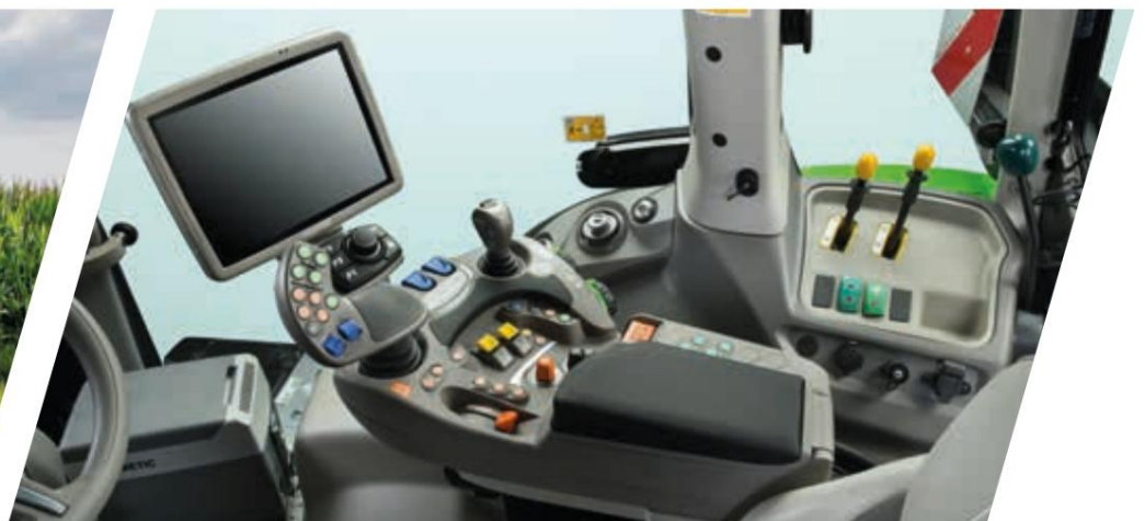
> Ergonomska igralna palica MaxCom z gumbi za dviganje, kontrolami motorja/menjalnika, gumbom za upravljanje ozare in dve proporcionalni krmilni enoti hidravličnega ventila.
