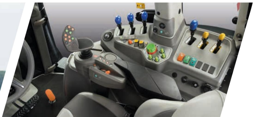
> Oprema kabine MaxiVision s popolnoma mehanskimi zadnjimi ventili v kombinaciji s Powershift (velika slika) in menjalnik RCshift (slika zgoraj).
