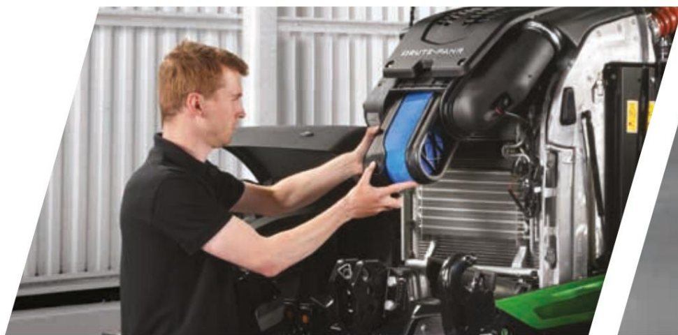
> Vsi modeli so opremljeni z zračnim filtrom PowerCore za dolgo življenjsko dobo.
