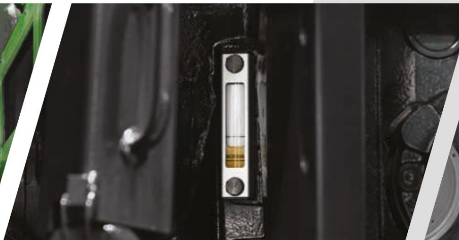
> Enostavno kontrolno steklo za olje na zadnjem delu traktorja.
