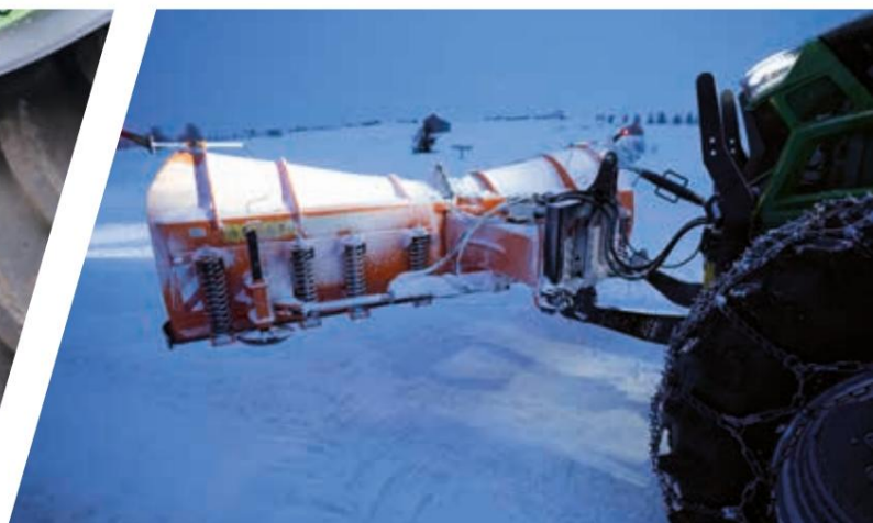
> Sprednji dvig z nadzorom razbremenitve omogoča prilagoditev kontaktnega pritiska priključka in prerazporedi težo na sprednjo os.
