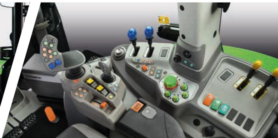
> Mešana konfiguracija z 2 mehanskimi razdelilniki in 2 električnima.
