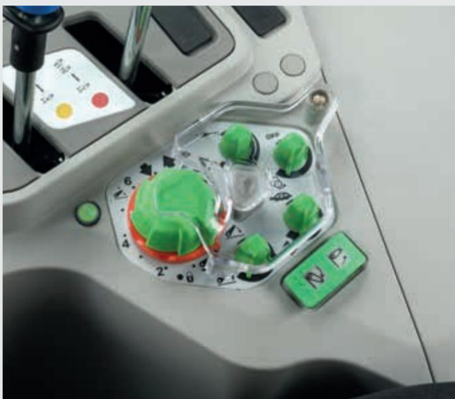
Elektronsko krmiljenje zadnjega dviga.
