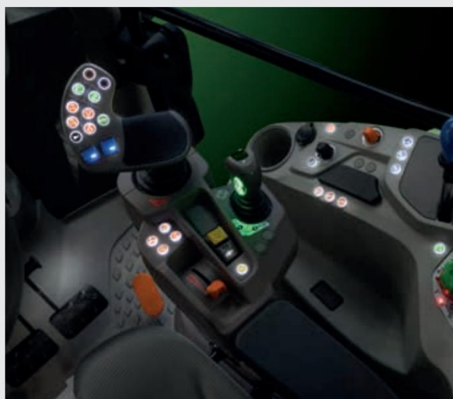
↑ Priznana krmilna palica MaxCom, ki je opremljena z različicami TTV, je zgoščen paket visoke tehnologije, ki vozniku omogoča upravljanje vseh glavnih funkcij stroja v popolnem udobju z eno roko.
