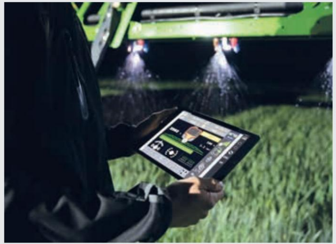
↑ Funkcija XTEND s tablico, upravljanje priključkov prek ISOBUS UT zunaj kabine.
