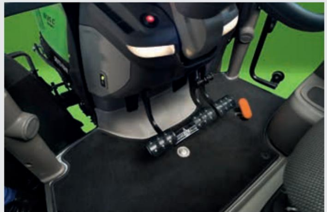
↑ Aktivacija hidravlične motorne zavore.
