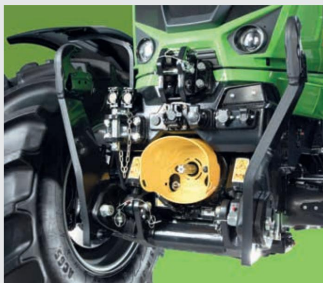
↑ Sprednji dvig z dvizno zmogljivostjo 5.450 kg in sprednjo priključno gredjo DualSpeed.
