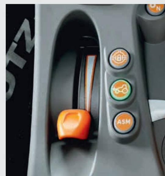
↑ Neodvisen ročni plin in elektrohidraulični vklop zapore diferenciala, štirikolesni pogon in avtomatska funkcija ASM.
