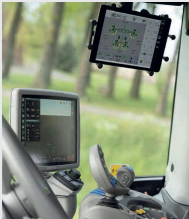
Funkcija XTEND omogoča prikaz SDF Guidance ali omogoča upravljanje priključka ISOBUS na zunanji napravi, npr. tablici.
