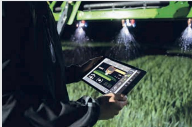
↑ Funkcija XTEND s tablico, upravljanje priključkov preko ISOBUS UT zunaj kabine.
