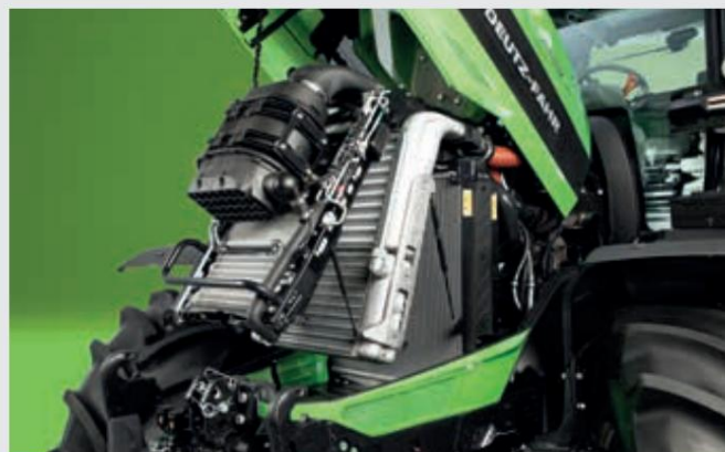
↑ Hladilni sistem iz aluminija z ročico za dostop z eno roko in zračnim filtrom Powercore.
