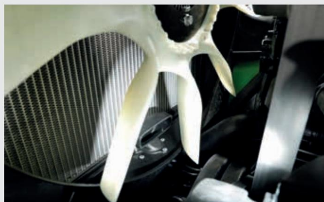
↑ Elektronski viskostatični ventilator (eVisco) s sesalno cevjo za sistem predčiščenja zračnega filtra.
