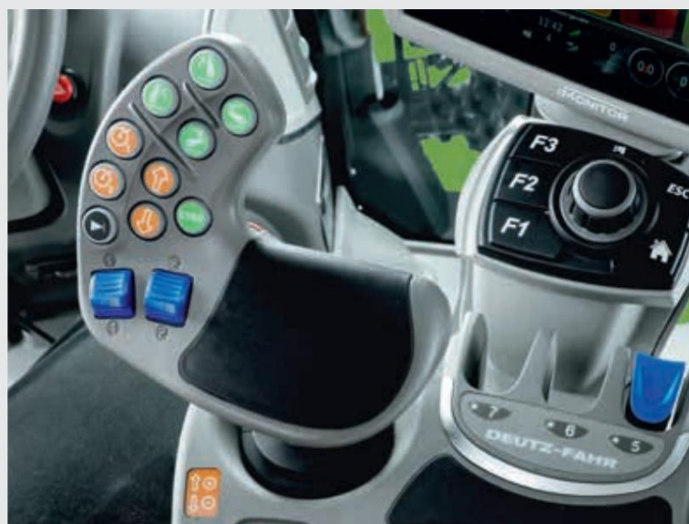
↑ Ergonomska igralna palica MaxCom s sprednjim in zadnjim dvigom, motorjem, menjalnikom, upravljanjem na ozari in dvema proporcionalnima krmilnima enotama hidravličnega ventila.
