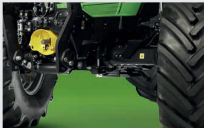
↑ Koncept sprednjega vzmetenja z visoko oddaljenostjo od tal in 3 nastavljivimi nivoji v notranjosti InfoCentrepro.
