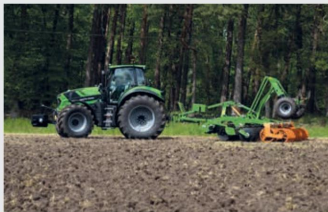
↑ Upravljanje ozar s funkcijo Auto-Turn in ComfortTippro razbremeni strojnika v zahtevnih situacijah.
